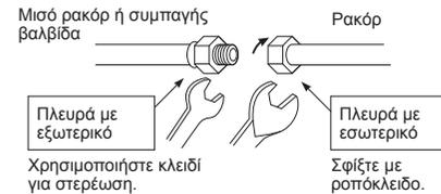
2. Όπως φαίνεται στην εικόνα, φροντίστε να χρησιμοποιήσετε δύο κλειδιά για να χαλαρώσετε ή να σφίξτε το ρακόρ της βαλβίδας της γραμμής αερίου. Αν χρησιμοποιήσετε μόνο κλειδί, το ρακόρ δεν μπορεί να συσφιχτεί με την απαραίτητη ροπή στρέψης. Από την άλλη πλευρά, χρησιμοποιήστε μονό κλειδί για να χαλαρώσετε ή να σφίξτε το ρακόρ της βαλβίδας της πλευράς υγρού.
